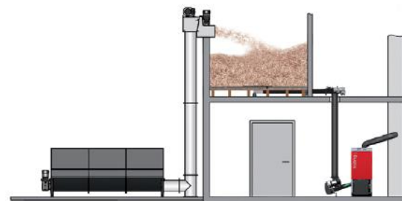
Riempimento con coclea verticale
